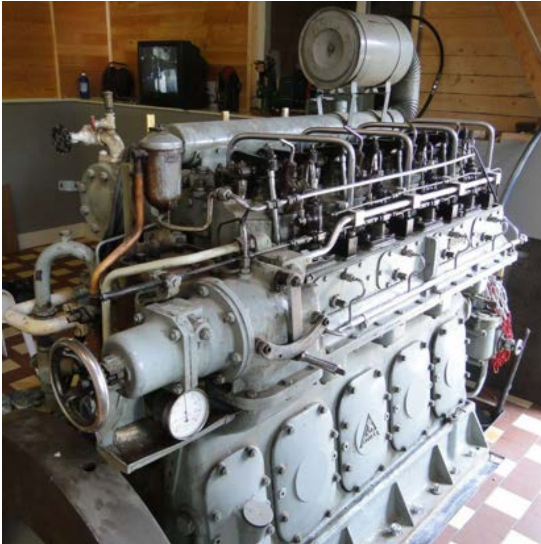
Reguleur, brandstofhendel en start- en stopinrichting van viercilinder Stork-Ricardo (Stoomgemaal De Tuut)
