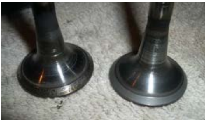
Links beschadigde klep Rechts de klep na het schuren
