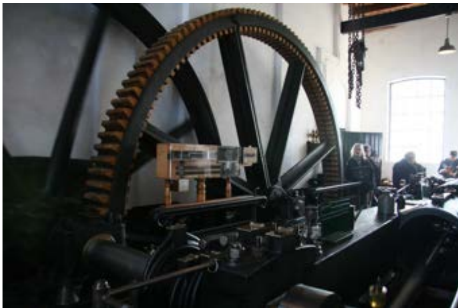
Voorbeeld van tandwiel met houten tanden (Stoomgemaal Hertog Reijnout)
