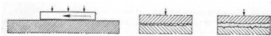
Principe van slepende wrijving
