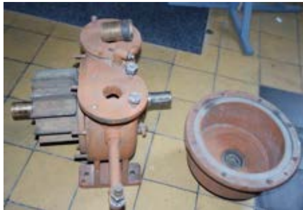
Onderdelen van de vacuümpomp in gedemonteerde toestand
